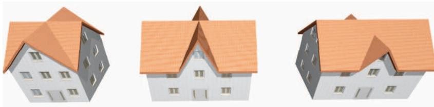
Das Kreuzdach weist gemäss dem Baurekursgericht zwei mittig gekreuzte, gleich lange Firste und acht Dachflächen auf. Alle Dachflächen sind dabei gleichförmig, alle Firste setzen auf gleicher Höhe an, die Dachflächen werden bis zur Fassade hinunter gezogen und die Giebeldreiecke verlaufen bündig mit der darunterliegenden Vollgeschossfläche.
